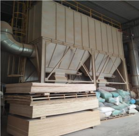
Hình 4. 6: Hình ảnh minh họa - Thiết bị xử lý bụi khâu cắt ván, đánh bóng (chà nhám)
